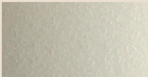
SALACEL-Uは包含された無数の細孔が表面に現れた構造をしています。表面に現れた孔が相手材との接触面積を減少させ、高度な剥離性を発揮させます。
